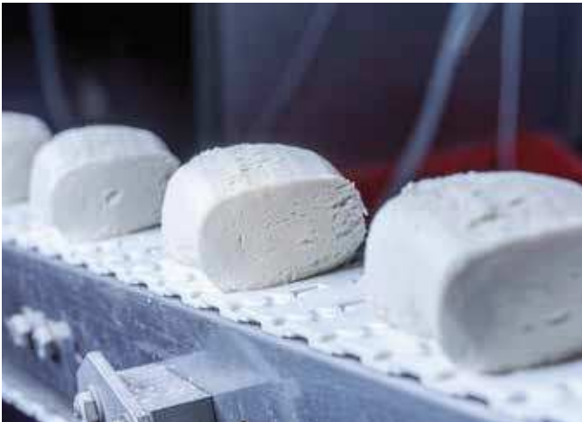
++ Volumetrisch geteilt läuft der Teig zu den Formstationen
